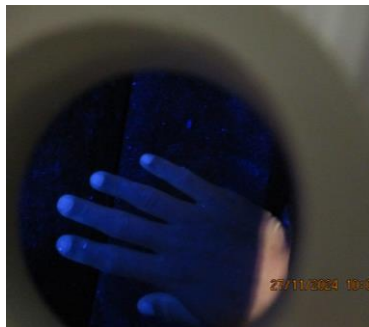
Überprüfung der Dichtigkeit von Einweghandschuhen mittels fluoreszierendem Händedesinfektionsmittel
